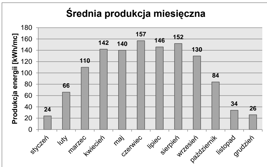
Wykres 11. Produkcja energii elektrycznej przez panele fotowoltaiczne
